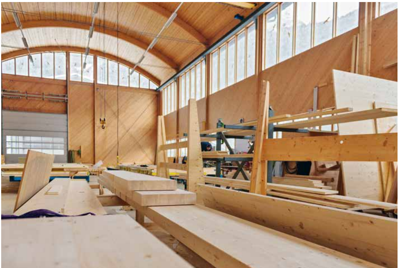
Die Rahmenbauelemente für Wände und Fassaden werden im eigenen Betrieb gefertigt.
