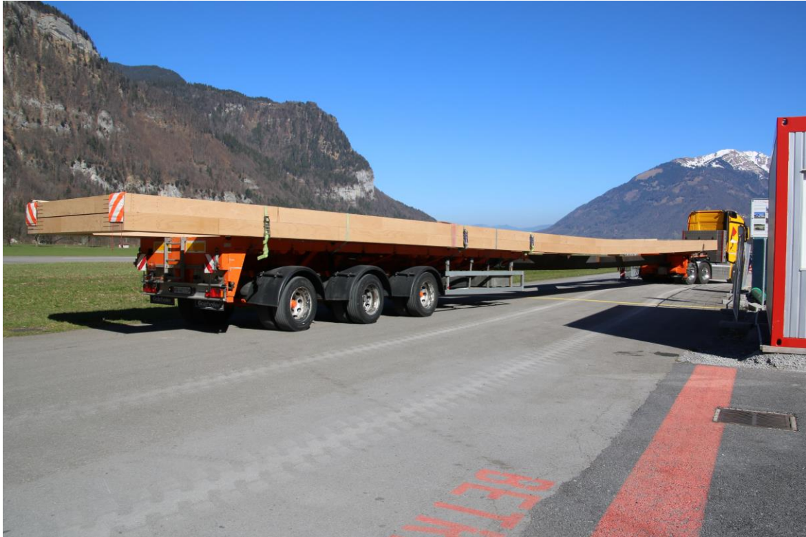
Spezialtransport des 30 Meter langen Abfangfachwerkes nach Mollis.
